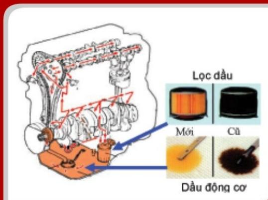
Ví dụ: Dầu động cơ có tác dụng bôi trơn, làm kín, làm mát, làm sạch và chống ăn mòn kim loại cho các bộ phận bên trong động cơ. Dầu động cơ được lọc sạch bằng lọc dầu, bộ phận này giữ lại các chất cặn và chất bẩn sinh ra trong quá trình vận hành của động cơ. Sau một thời gian sử dụng các tính năng của dầu và lọc dầu sẽ giảm
